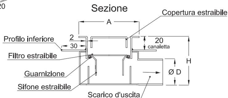
IDrain 3090 - Canaletta con copertura standard a doppia fessura - Larghezza mm 70 - Bordi a vista - scarico Ø 40 centrale orizzontale - sifone e filtro estraibili - Con profilo inferiore in acciaio inox per isolamento su massetto di posa.
