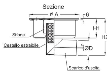
**IDrain 0010 - Chiusino con copertura in piastra forata spessore mm 6 Forma quadra - Scarico orizzontale sifonato - Cestello estraibile**
