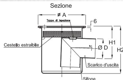
**IDrain 0011 - Chiusino con copertura in piastra forata spessore mm 6 Forma quadra - Scarico orizzontale ultraribassato, sifonato - Cestello estraibile**
