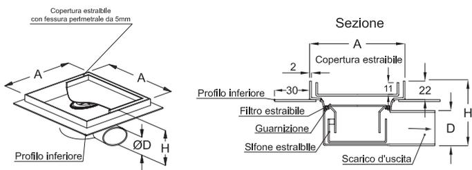
**IDrain 3276 - Piletta con copertura pavimentabile a fessura perimetrale - Forma quadra - Senza bordi scarico orizzontale - sifone e filtro estraibili - Con profilo inferiore in acciaio inox per isolamento su massetto di posa**
