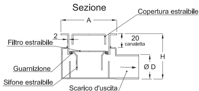
**IDrain 3080 - Canaletta con copertura standard a doppia fessura**
