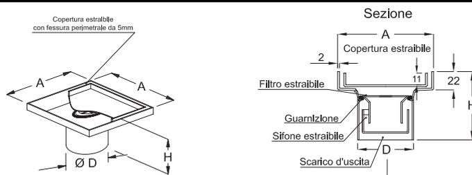
**IDrain 3268 - Piletta con copertura pavimentabile a fessura perimetrale Forma quadra - Senza bordi - scarico verticale - sifone e filtro estraibili**
