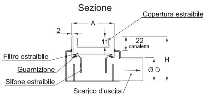
**IDrain 3280 - Canaletta con copertura pavimentabile a doppia fessura Larghezza mm 54 - Senza bordi - scarico Ø 40 centrale orizzontale - sifone e filtro estraibili**
