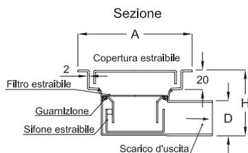
**IDrain 3066 - Piletta con copertura standard a fessura perimetrale Forma quadra - Bordi a vista - scarico orizzontale - sifone e filtro estraibili**
