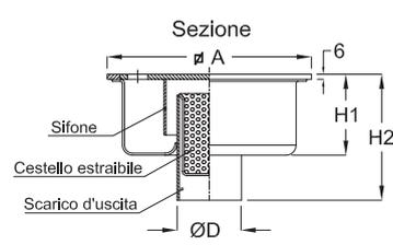
**IDrain 0013 - Chiusino con copertura in piastra forata spessore mm 6 Forma quadra - Scarico verticale sifonato - Cestello estraibile**
