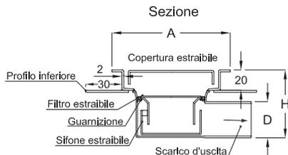
**IDrain 3076 - Piletta con copertura standard a fessura perimetrale - Forma quadra - Bordi a vista scarico orizzontale - sifone e filtro estraibili - Con profilo inferiore in acciaio inox per isolamento su massetto di posa**
