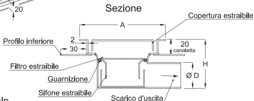
IDrain 3070 - Canaletta con copertura standard a doppia fessura - Larghezza mm 100 - Bordi a vista - scarico Ø 40 centrale orizzontale - sifone e filtro estraibili - Con profilo inferiore in acciaio inox per isolamento su massetto di posa.
