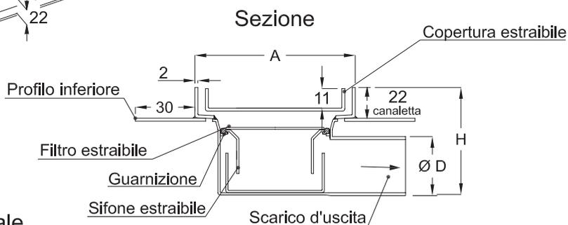
**IDrain 3270 - Canaletta con copertura pavimentabile a doppia fessura - Larghezza mm 84 - Senza bordi - scarico Ø 40 centrale orizzontale - sifone e filtro estraibili - Con profilo inferiore in acciaio inox per isolamento su massetto di posa.**
