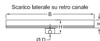
\* N.B.: - Tutte le misure possono essere variate a richiesta - Possibilità di costruzione con profilo inferiore in Acciaio Inox per isolamento su massetto di posa.
