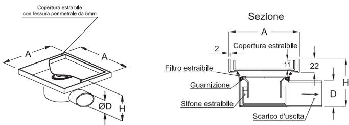
**IDrain 3266 - Piletta con copertura pavimentabile a fessura perimetrale Forma quadra - Senza bordi - scarico orizzontale - sifone e filtro estraibili**
