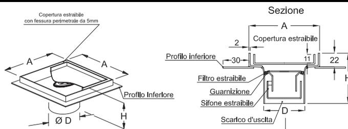
**IDrain 3278 - Piletta con copertura pavimentabile a fessura perimetrale - Forma quadra - Senza bordi scarico verticale - sifone e filtro estraibili - Con profilo inferiore in acciaio inox per isolamento su massetto di posa**
