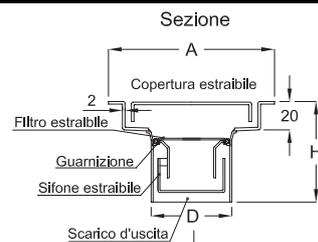
**IDrain 3068 - Piletta con copertura standard a fessura perimetrale Forma quadra - Bordi a vista - scarico verticale - sifone e filtro estraibili**
