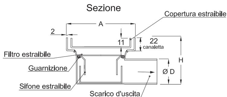
**IDrain 3260 - Canaletta con copertura pavimentabile a doppia fessura**
