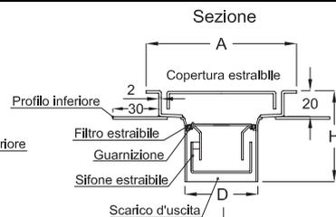
**IDrain 3078 - Piletta con copertura standard a fessura perimetrale - Forma quadra - Bordi a vista scarico verticale - sifone e filtro estraibili - Con profilo inferiore in acciaio inox per isolamento su massetto di posa**
